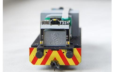
Menšie závažie netreba brúsiť. Stačí zrezat z plastovej koľajničky 0,5mm a závažie zaizolovať zo zadnej strany tak, aby sa nedošlo k skratu na kontaktoch motora. V prípade skratu na motore alebo čelnom osvetlení sa dekodér nepoškodí.
