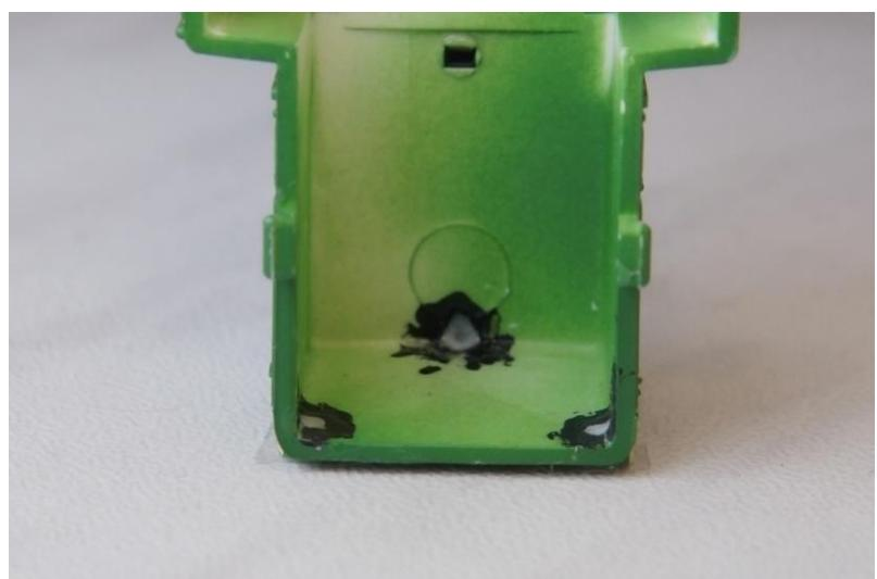
V ďalšom kroku potrebné upraviť vnútornú dĺžku modelu, aby sa do modelu vošli čelné plošné spoje s osvetlením. Väčšie závažie treba po okrajoch zbrúsiť asi o 0,5mm a na vrchnej časti zaizolovať kvôli možnému skratu na plošnom spoji s čelným osvetlením.
